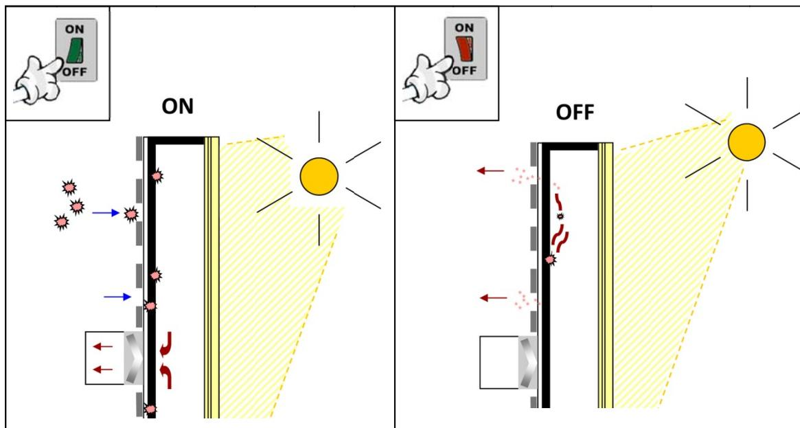
Setzen Sie die Selbstreinigung des Filters in Gang, indem Sie das System mindestens einmal jährlich unter voller Sonneneinstrahlung ausschalten. Die Temperatur im Warmluftkollektor steigt nun zu einem Niveau an, bei dem organische Staubpartikel, die sich im Filter festgesetzt haben, austrocknen. Nach ein paar Stunden ist der Filter gereinigt und Sie können den Warmluftkollektor wieder in Betrieb nehmen.
